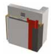
Jonction à un mur existant
