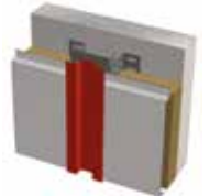
Jonction entre lames / à joint creux
