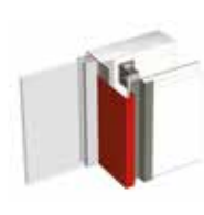
Ouverture / Jambage à joint creux
