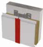
Jonction entre lames / à aiguille inversée
