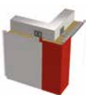
Angle sortant / type lame pliée
