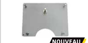
Ø 112 / 300 - Ø 252 - Poids 31kg Longueur : 60 cm - Largeur : 45 cm Épaisseur : 1.5 cm Acier galvanisé Tapis caoutchouc de protection MC3142
