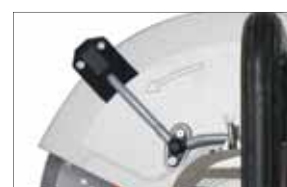
Arrivée d'eau pour la coupe sous arrosage
