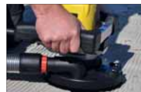
Double poignée anti-vibration
