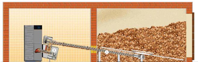
1. TUB : Thermostat de contrôle de température du stockage
