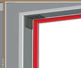
JOINT D'ÉTANCHÉITÉ EPDM SUR DORMANT + OUVRANT
