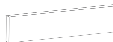
Płytki elewacyjna Brick slip DF - 52 x 240 x 14 mm
