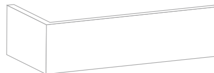
Płytki kątowa Corner brick slip RF - 120/250 x 65 x 10 mm
