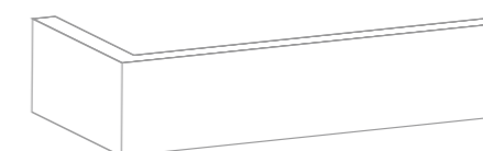
Płytki kątowa Corner brick slip DF - 115/240 x 52 x 14 mm
