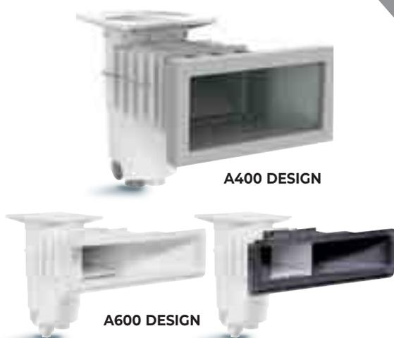
**Skimmer A400 ET A600** pour piscine liner et béton. Série DESIGN avec coins carrés, en ABS blanc. Meurtrière large sur modèle A800. Skimmer livré en 2 parties : corps et meurtrière, à assembler au montage (collage pour ABS). Traversée de paroi : 305 mm.
