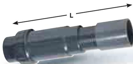
Le compensateur de dilatation permet d'absorber en toute sécurité l'extension des tubes induite par les variations de température. Il permet aussi le montage et le démontage d'équipements installés dans des emplacements difficilement accessibles ou la réparation de tube. Mouvement axial. Corps : PVC-U. Joints : EPDM. Température : 0 °C à 60 °C.
