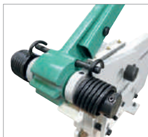
Sécurité : ressort de rappel sur la lame supérieure
