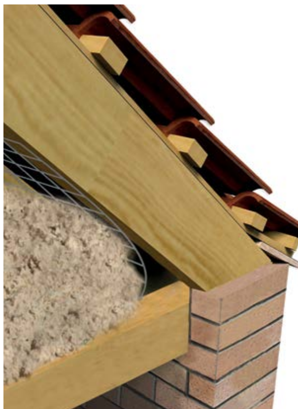
Découpe et pliage du grillage en correspondance des entrails (gauche) et maintien de l'aération (droite)
