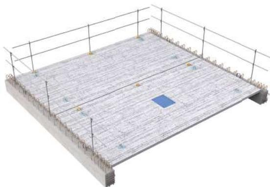
Les DAK Prédalles sont disposés à 15 cm de la rive pour faciliter le positionnement de la Prédalle suivante.
