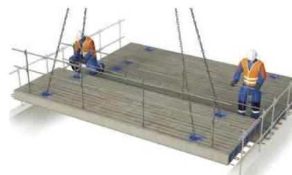
Les DAK sont positionnés à 11,5 cm de la rive pour faciliter le positionnement de la Dalle Alvéolée suivante, qui arrive déjà sécurisée.
