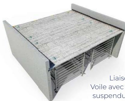
Liaison Plancher Prédalle Voile avec Engravure, Prédalles suspendues en zone sismique
