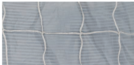
Sous-face consorex 50g/m 2 et film souple
