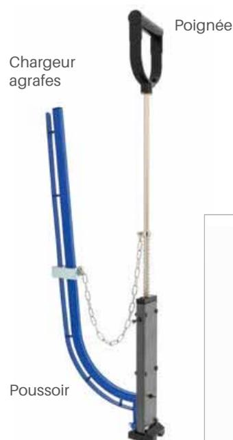
① Positionner la première barrette d'agrafes de façon à ce que la première agrafe soit parfaitement enclenchée dans la fenêtre et vienne en butée contre la paroi métallique. Si vous rencontrez une difficulté de mise en œuvre des agrafes, réglez la vis en façade pour déplacer la guillotine de découpe.
