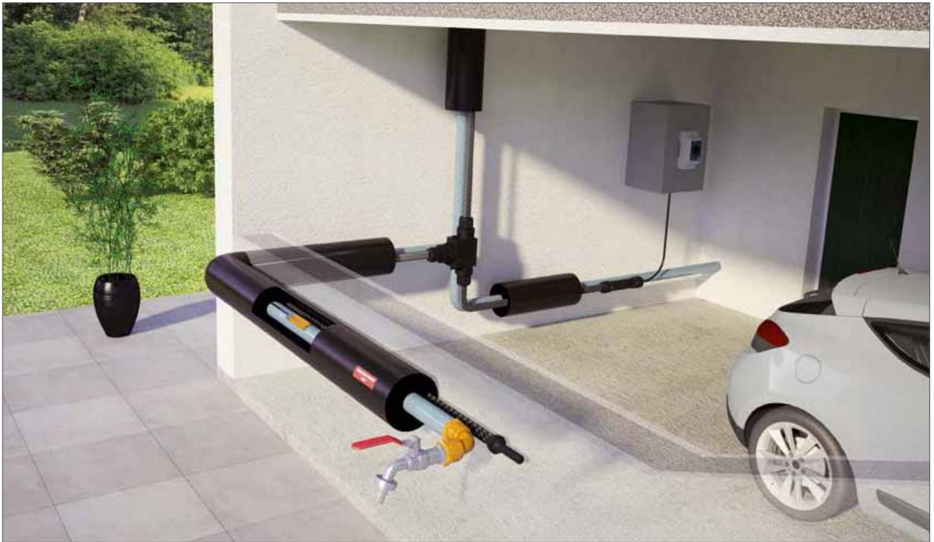
Le câble chauffant Autorégulant est un câble composé de deux conducteurs métalliques noyés dans une matrice constituée d'un polymère aux caractéristiques particulières.
