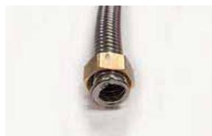
**7** Dévisser complètement le raccord IM : le collet battu est réalisé.
