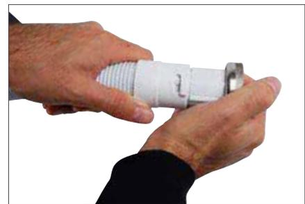
Emboîter le tuyau extensible avec le **raccord écrou tournant** : pousser, tourner.
