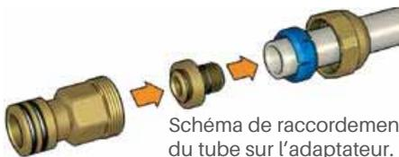
Schéma de raccordement du tube sur l'adaptateur.
