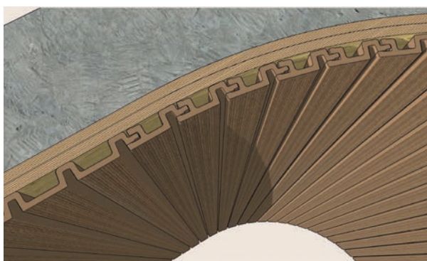
Pose verticale sur mur courbe concave de rayon 1 mètre mini
