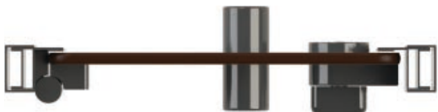
Bloc-porte standard avec profil de rattrapage d'aplomb (10 mn par côté)
