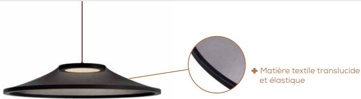
Suspension LED 2700K. Version avec patère ou patère encastrable (prévoir accessoire non inclus). Puissance 5W, 800lm. Câble de suspension 2600mm. Variable coupure de phase, DALI, Non Dim
