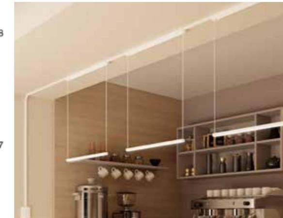
Suspension linéaire pour systèmes PRO-INK. Puissances 9W, 12W, 22W ou 29W. 2700K (uniquement en on-off)/3000K, faisceaux medium flood 58° ou diffus 139,4°. Câble 2000mm maxi. IP40. Classe III. Compatible DALI 2.
