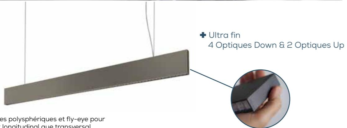
Suspension avec micro-optiques polysphériques et fly-eye pour un confort visuel maximal, tant longitudinal que transversal, assuré par un UGR<19. CCT 2700/3000/3500/4000K. 4 options de distribution lumineuse directe (35°, 52°, 70°, 82°) et 2 optiques indirectes 105° ou Batwing. IP40. Durée de vie L90B10 100 000h. Variable DALI, Casambi, Push.
