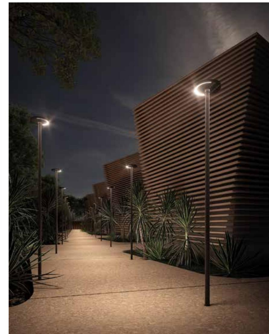
Tête de mât LED, forme ronde avec diffusion de la lumière sur 180° ou 360°. IP65. Températures de couleur : 2200K / 2700K / 3000K / 4000K. Dimmable. Traité bord de mer. Pré-câblé. IK08. IRC80. Durée de vie L90B10 60 000h. Recommandé pour l'installation sur des poteaux métalliques de Ø60. Ne convient pas aux Still poteaux. Câble version ON-OFF : 1m H05RN-F 2x1. Câble version DALI : 1m H07RN-F 4x1.
