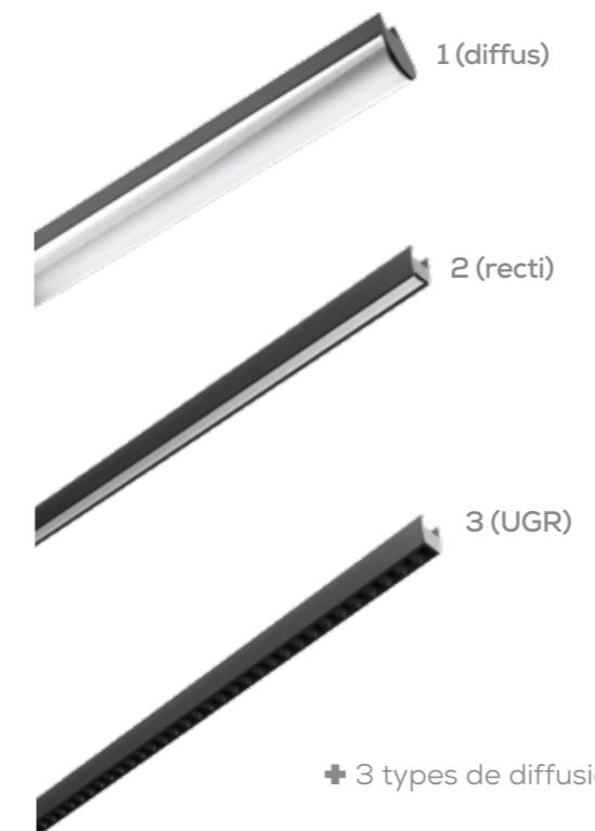
Modules LED linéaires pour systèmes PRO-INK. A cliper dans le rail compatible. 3 types de diffusion. 2700K (uniquement en on-off)/3000K. Différentes puissances et longueurs. IP40. Classe III. Compatible DALI 2.
