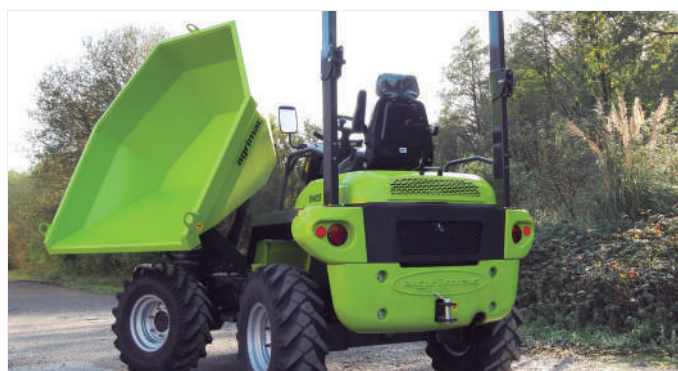
Véhicule articulé avec décharge pivotante à 180°
