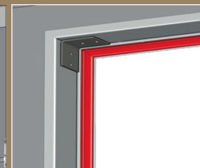
JOINT D'ÉTANCHÉITÉ EPDM SUR DORMANT + OUVRANT
