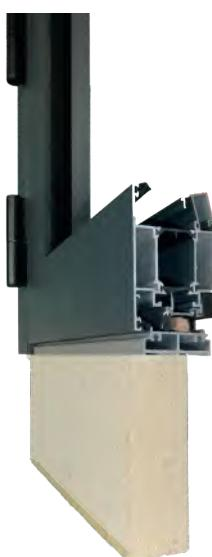
Grâce à son très haut pouvoir isolant et sa forte résistance à la compression, ils remplacent avantageusement le traditionnel rejingot béton sous les seuils et facilite la pose de menuiseries sans pont thermique au niveau de la dalle.
