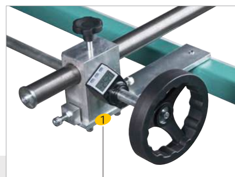
Butée arrière à crémaillère, lecture sur compteur digital
