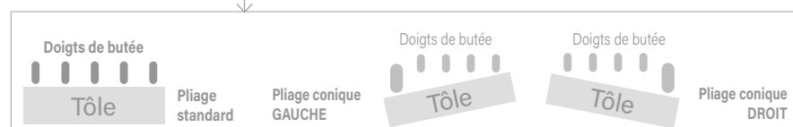
Pliage conique pneumatique, réglage manuel
