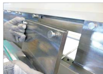
1 Démontage rapide des segments par tirette
