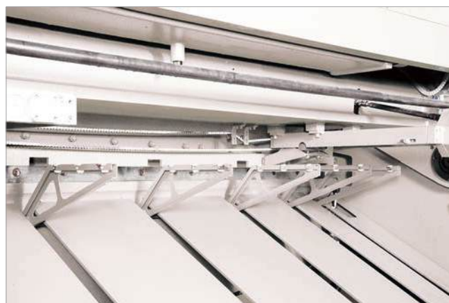
(7) Peigne soutien de tôle pneumatique
