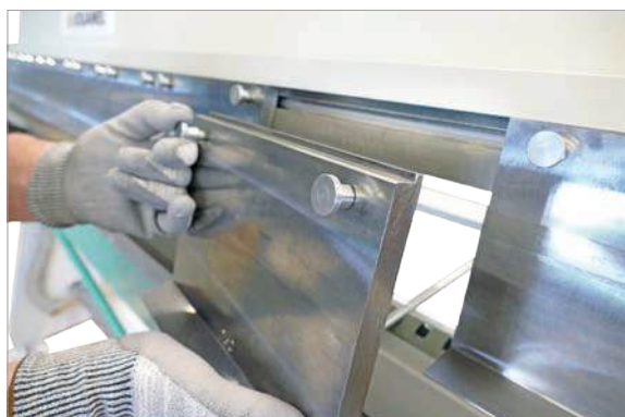
1 Démontage rapide des segments par tirette
