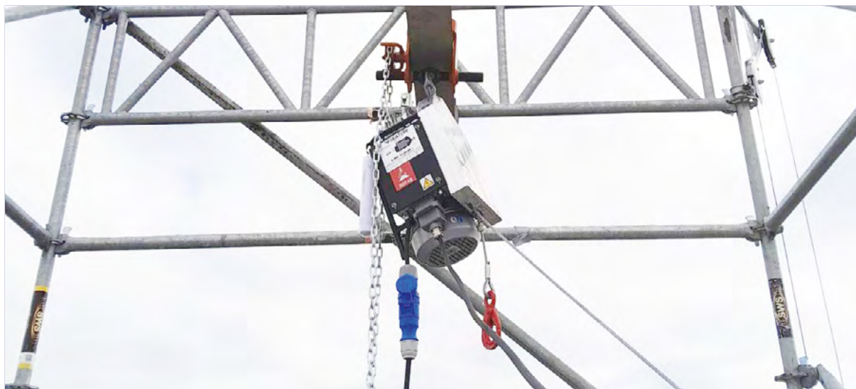
Treuil électrique 500 kg (réf. LM 500)
