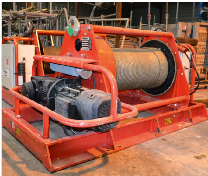
Treuil de tirage électrique 6 000 kg avec variateur de vitesse (réf. TT 6 000 VV)
