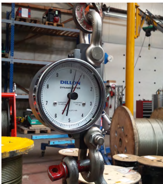
Peson manuel à aiguille 1 000 kg (réf. PESON1T / AIGUIL)
