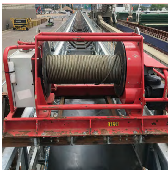
Treuil électrique 5 000 kg avec variateur de vitesse (réf. TE 5 000 VV)
