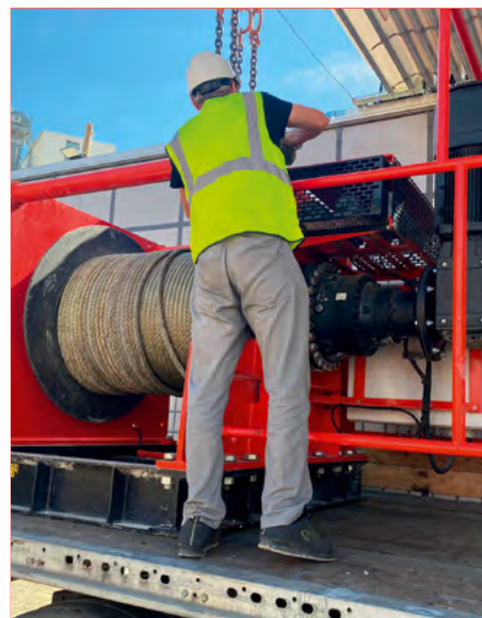
Treuil au sol 25 000 kg avec variateur de vitesse (réf. Treuil au sol TR 25 000 VV)
