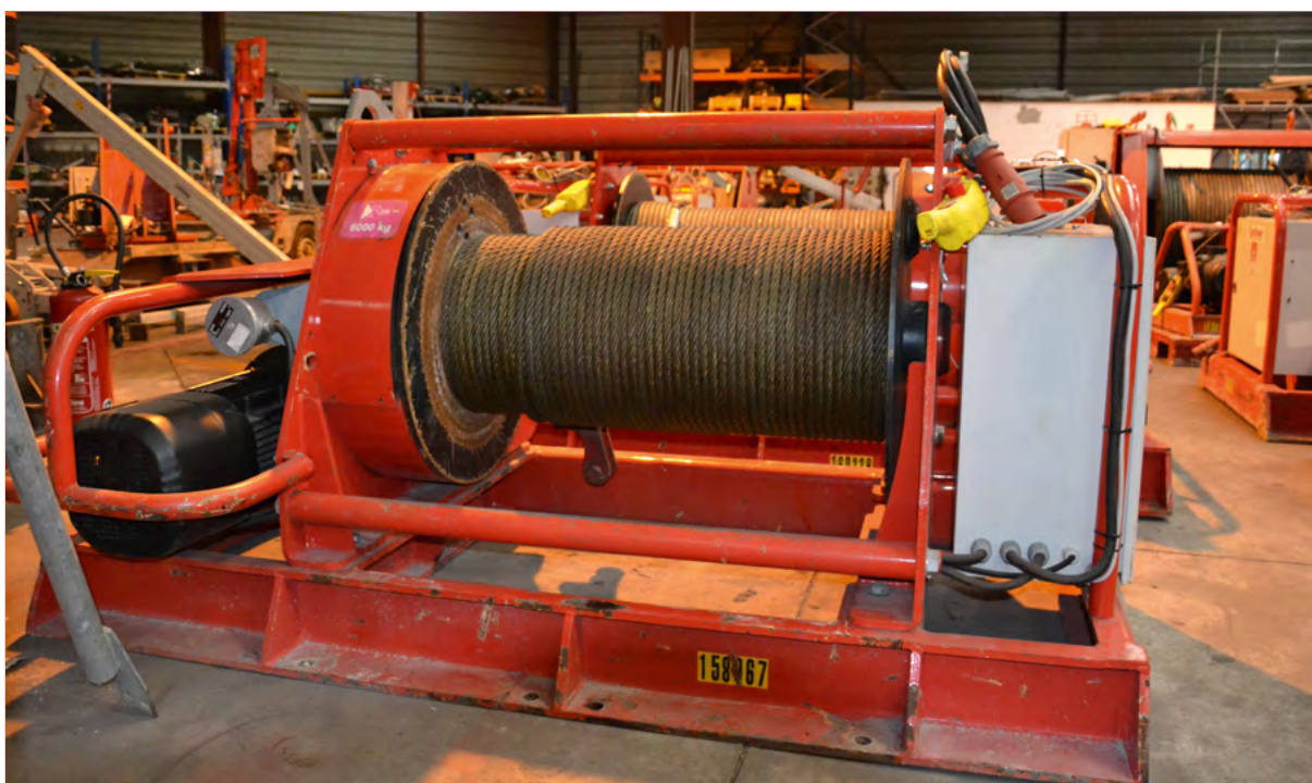
Treuil de tirage électrique 6 000 kg avec variateur de vitesse (réf. TT 6 000 VV)
