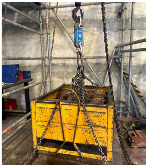
Peson dynafor 6500 kg (réf. PESON6.5T / ELECTR)
