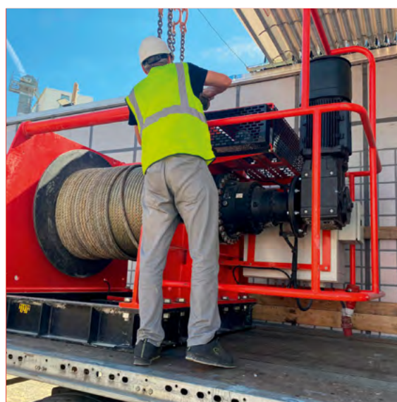
Treuil au sol 25 000 kg avec variateur de vitesse (réf. Treuil au sol TR 25 000 VV)
