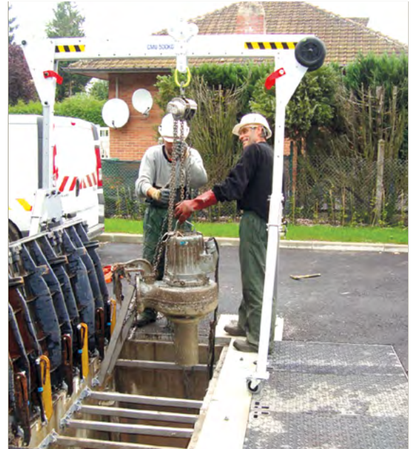
Portique roulant 500 kg (repliable) (réf. PR 500 / 2 m repliable)
