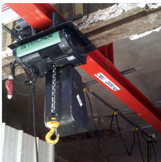
Palan électrique à chaîne 2 000 kg (réf. PE 2000)
