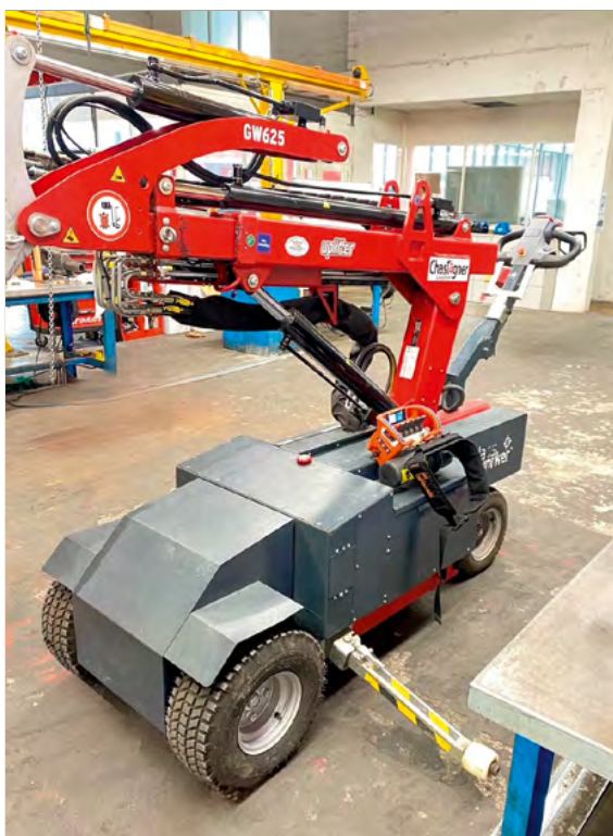
Robot de pose 625 kg (réf. GW 625-2)
