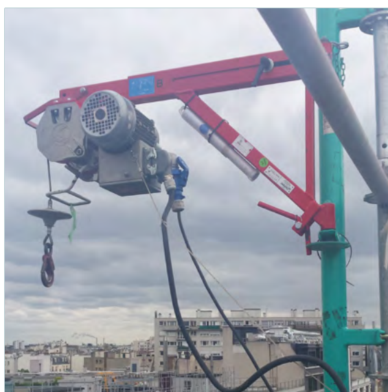
Treuil potence télescopique avec benne basculante trapézoïdale (réf. TR 225)
