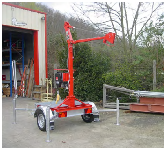
Grue GS 250 sur remorque (réf. OSSATURE / GS250R)
