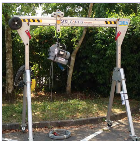
Treuil électrique 1 000 kg (réf. MOTRIX 1 000)
