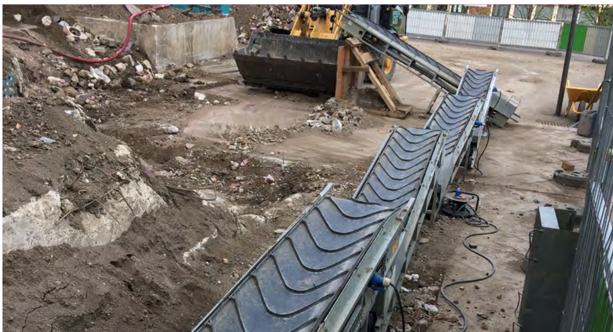
Convoyeur à bande 4,5 M (réf. COBA 4 500)
