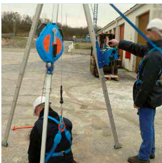
Trépied avec treuil antichute (réf. LP 100 – LP 101)
