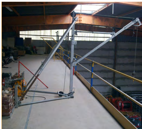
Grue Sodenic électrique 250kg (réf. OSSATURE / TRC300)
